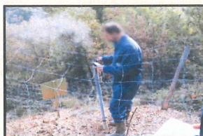
A Bois d'Asson, la combustion de niveaux de lignite et de schistes bitumineux dans l'ancienne mine est surveillée par un dispositif automatique de mesures de températures des fumées en surface et de télétransmission de ces données.
