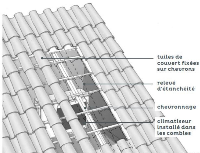
**Schéma de principe : unité extérieure intégrée dans le volume de la toiture, sur dalle étanche avec récupération des eaux. Les tuiles de couvert prolongent l'aspect de la toiture, le volume est ventilé par l'absence des tuiles de courant.**
