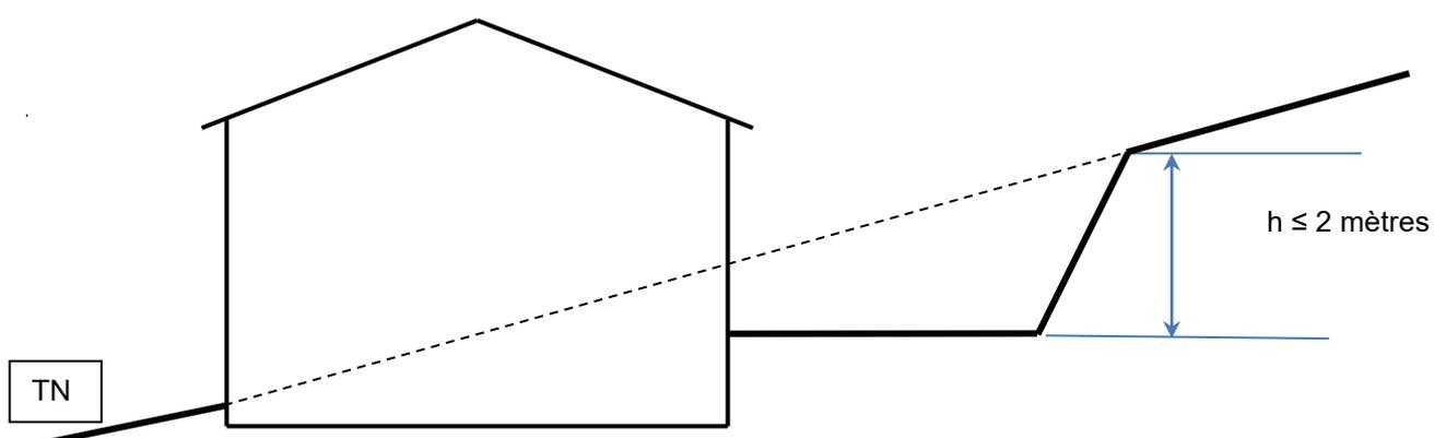
La distance (d) entre deux talus ou soutènements sera supérieure ou égale à la hauteur (h) du talus ou soutènement inférieur avec un minimum de 1 mètre
